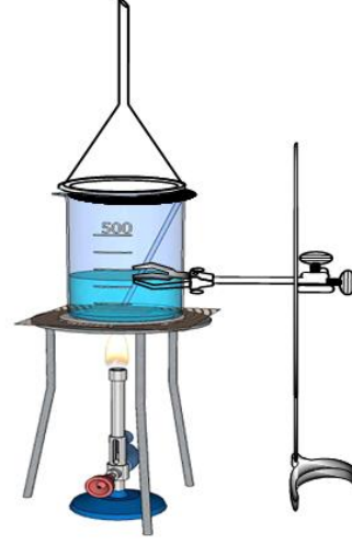
Şekil 10.3 Süblimleşme olayı ve naftalinin süblimleşmesine ait deney düzeneği
